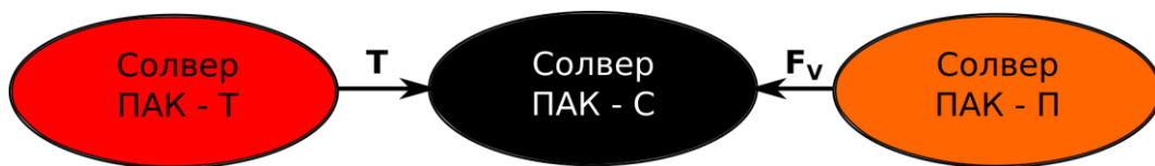
Слика 2 Размена података између солвера за структурну, термичку и филтрациону анализу
