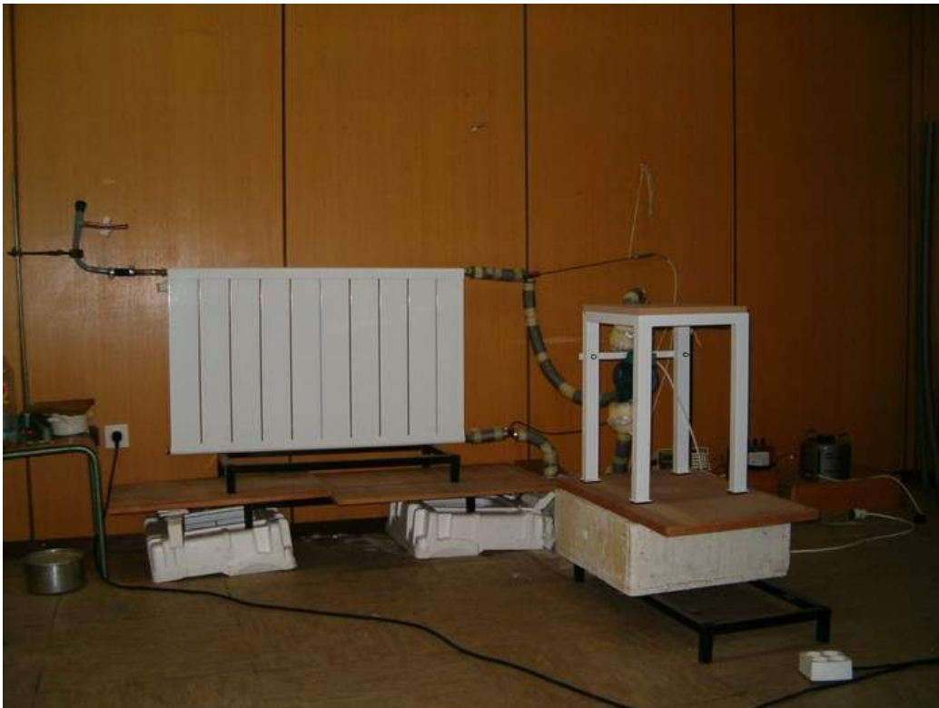
Слика 8 Фотографија мерне инсталације са монтираним радијатором Р 600/10
