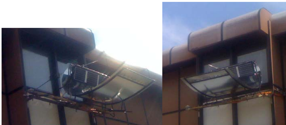
Слика 10. Монтирани концентратор на прозору лабораторије усмерен ка југу (поглед са југозападне и југоисточне стране)
