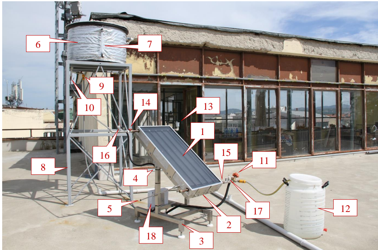
Слика 3.1 – Експериментална инсталација за испитивање фиксних соларних пријемника са отвореним циркулационим кругом и концепт ФРЗСП.
