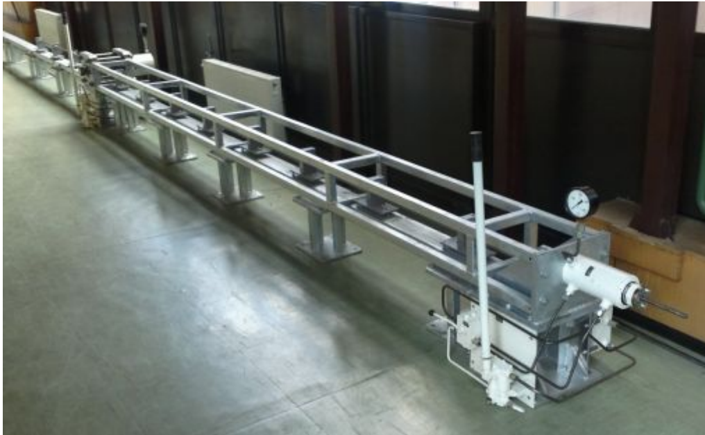
Слика 12. Решеткаста конструкција
