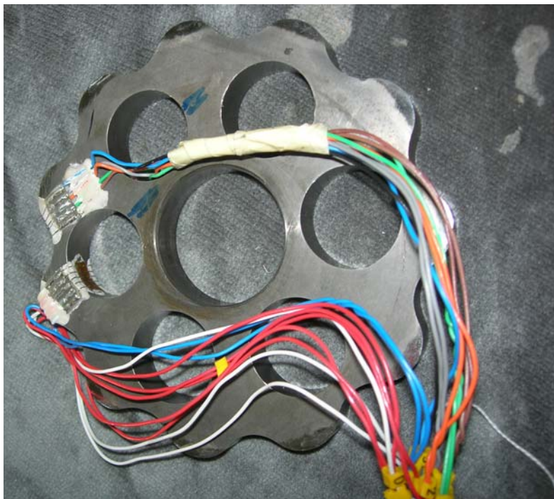
Слика 9: Фотографија циклозупчаника првог степена преноса са залепљеним мерним тракама
