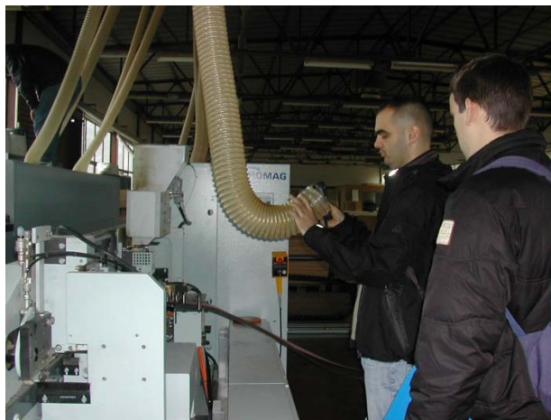
Слика 13. Мерење брзине струјања ваздуха обртним анемометром; а) анемометар; б) мерење брзине струјања ваздуха
