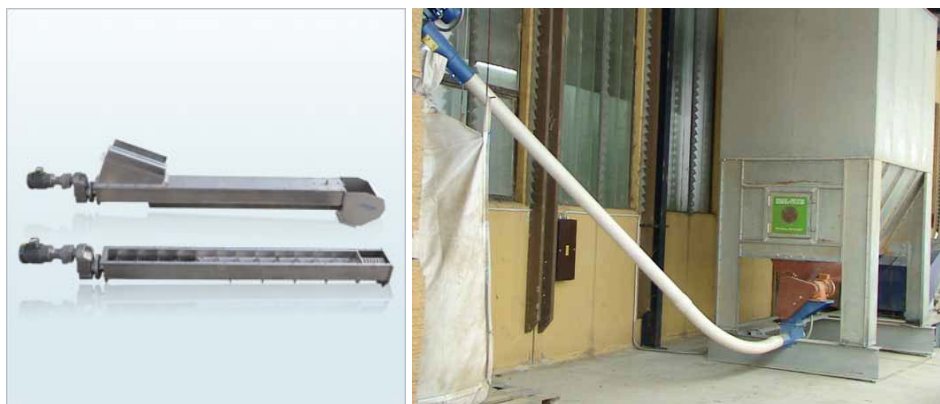
Слика 6. Пужни транспортер; лево фиксни, десно флексибилни
