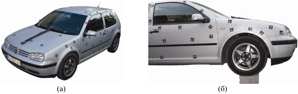
Слика 12: Каросерија аутомобила у пуној величини: (а) мерни објекат припремљен за извођење мерења и (б) оптерећивање објекта
