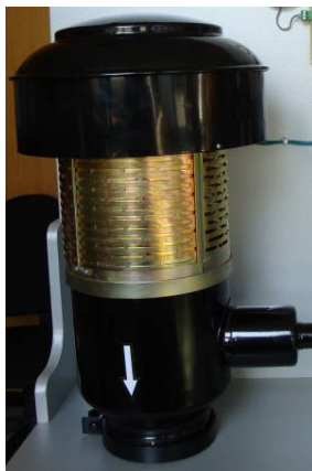
Слика 10. Реализовани прототип Интелигентног предпречистача
