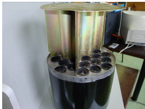
Слика 6. Подела циклона у секције
