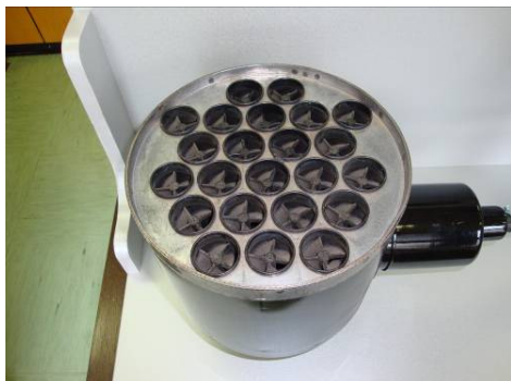
Слика 5. Рапоред циклона у предпречистачу
