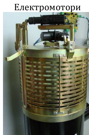
Слика 7. Управљачки део Интелигентног предпречистача са: а) затвореним, б) отвореним жалузинама
