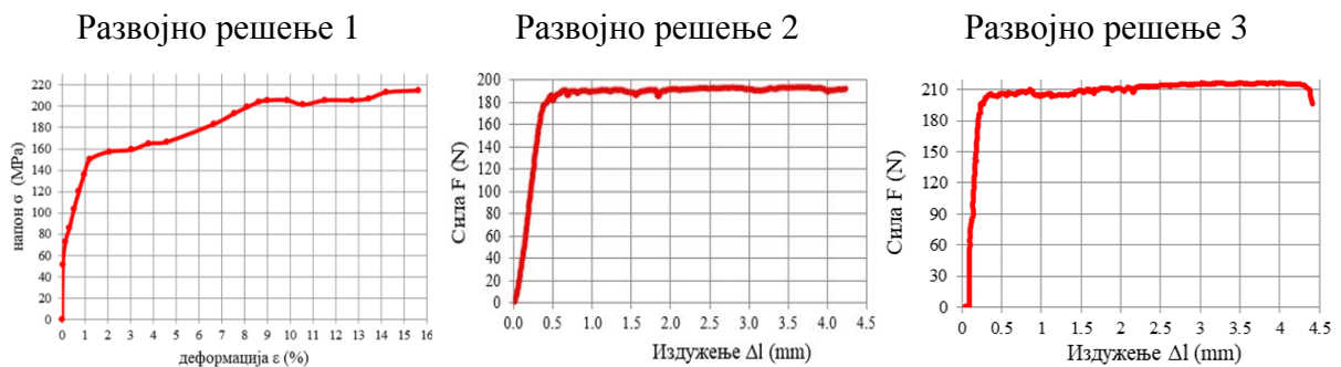
Слика 4. Приказ дијаграма сила-издужење односно напон-деформација добијених испитивањем затезањем на три развојна решења мале лабораторијске кидалице
