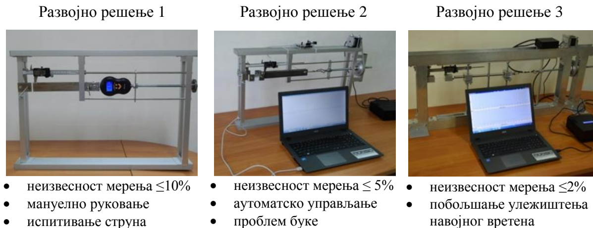
Слика 3. Приказ развојних решења, три варијанте мале лабораторијске кидалице
