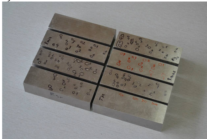
Слика 6. Фотографски приказ а) узорка стезног елемента и б) узорка предмета обраде.
