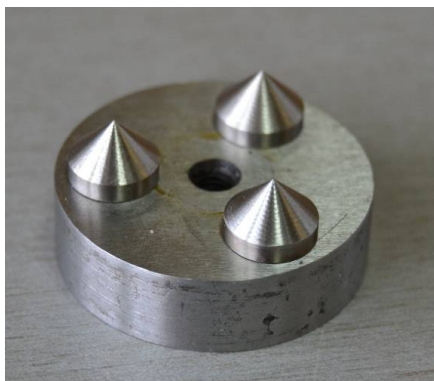
Слика 6. Фотографски приказ а) узорка стезног елемента и б) узорка предмета обраде.
