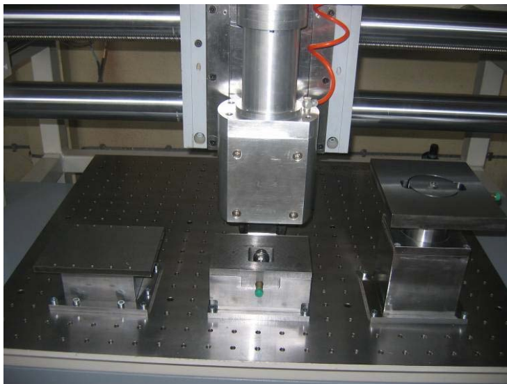
Слика 5. Фотографски приказ универзалног трибометра – триболошког мерног центра – детаљ вертикалног позиционирања контактних парова.
