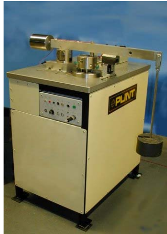
Слика 1. Мерни систем изведен преко дефинисане тежине (нормална сила) и тензометријских давача (сила трења).
