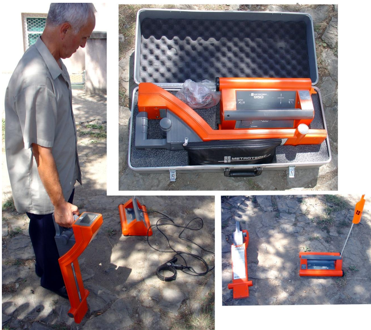
Слика 2. Трагач SEBA KMT METROTECH FM 9850
