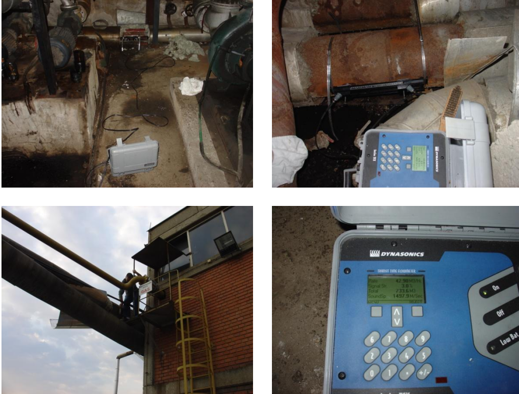
Слика 4. Мерење протока ултразвучним портабл протокомером
