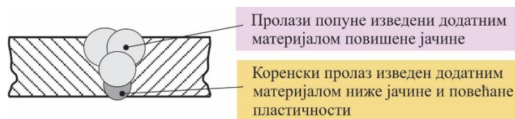
Слика 20. Заваривање додатним материјалима различитих јачина
