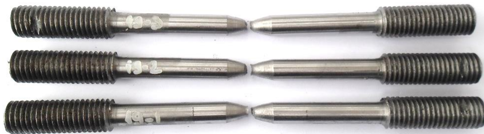
Слика 115. Изглед епрувета од основног материјала са U -жлебом по обиму радијуса 20\text{ mm} после испитивања
