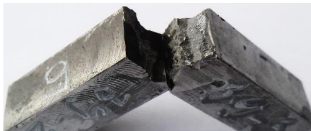
Слика 194. Изглед места прелома код епрувете са зарезом у зони стапања са стране корена завареног споја изведеног варијантом МИГ/МАГ после испитивања
