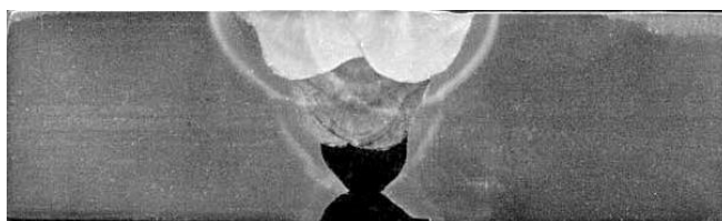
Слика 32. Макрофотографија попречног пресека завареног споја РЕЛ/МАГ
