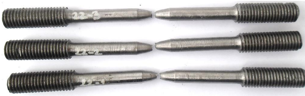
Слика 121. Изглед епрувета од основног материјала са U -жлебом по обиму радијуса 30 mm после испитивања затезањем
