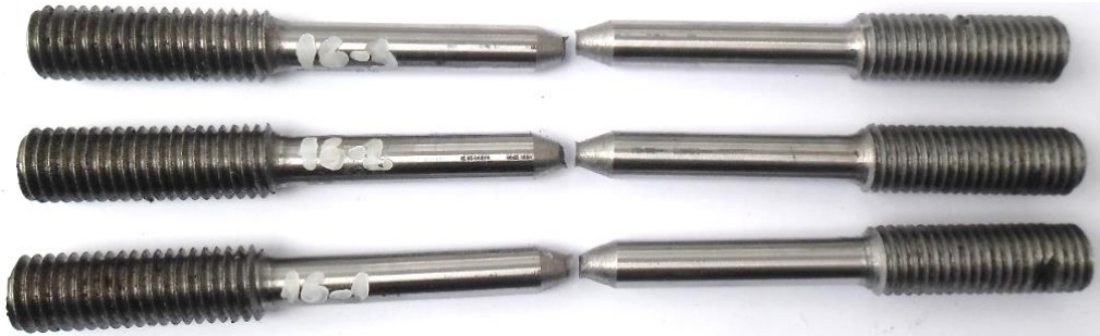
Слика 109. Изглед епрувета од основног материјала са U -жлебом по обиму радијуса 10 mm на половини мерног дела после испитивања
