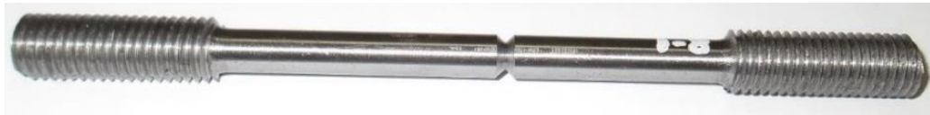
Слика 90. Облик, димензије и изглед епрувете са V-жлебом по обиму на 5 mm од осе завареног споја варијанте РЕЛ/МАГ или МИГ/МАГ
