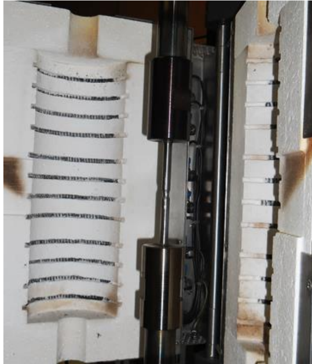
Слика 128. Електрични грејачи у комори за загревање епрувета
