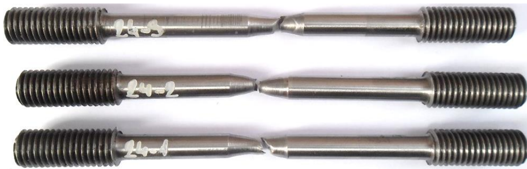
Слика 123. Изглед епрувета са варијантом МИГ/МАГ завареног споја са U -жлебом по обиму радијуса 30 mm после испитивања затезањем
