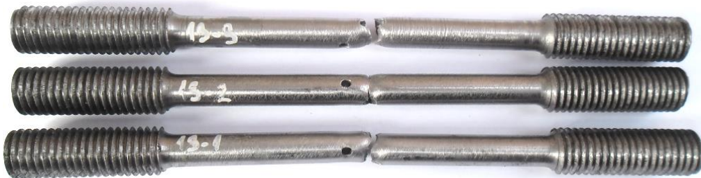
Слика 103. Изглед серије епрувета са мимоилазним отворима на растојању 5 mm после испитивања
