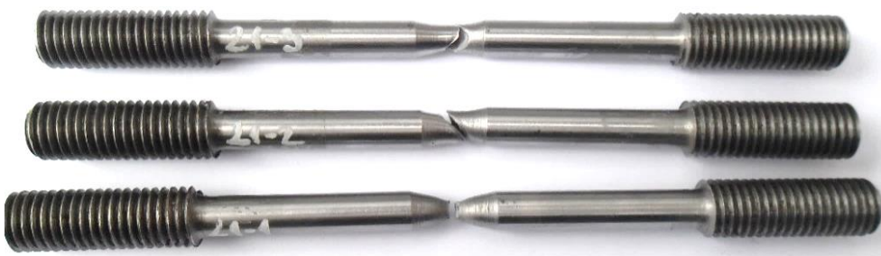
Слика 117. Изглед епрувета са МИГ/МАГ варијантом завареног споја и U -жлебом по обиму радијуса 20\text{ mm} после испитивања затезањем
