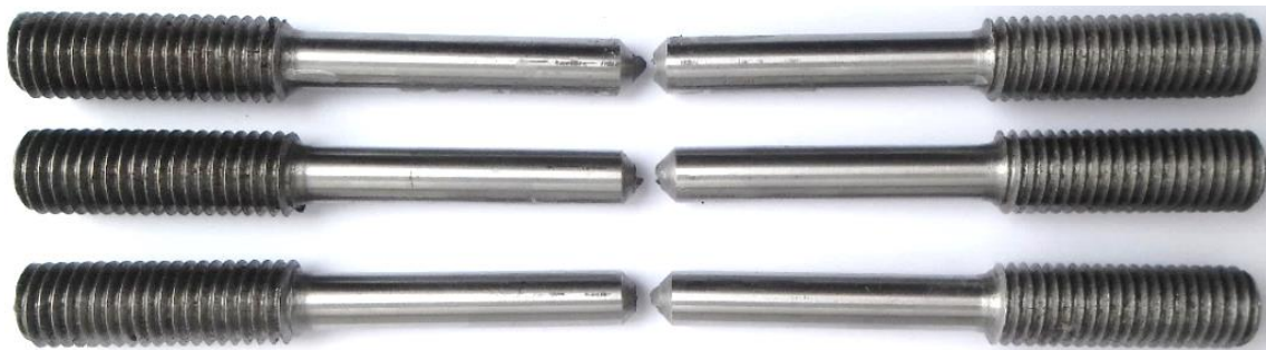
Слика 89. Изглед епрувета са варијантом РЕЛ/МАГ завареног споја и V-жлебом по обиму чије се осе поклапају после испитивања
