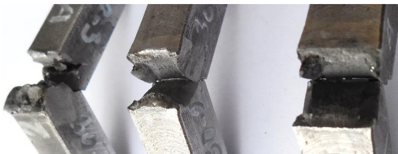
Слика 204. Изглед места прелома код епрувета са зарезом у оси са стране лица завареног споја изведеног варијантом РЕЛ/МАГ после испитивања
