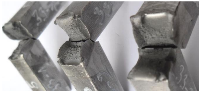
Слика 184. Изглед места прелома код епрувета са зарезом у зони стапања са стране лица завареног споја изведеног варијантом МИГ/МАГ после испитивања
