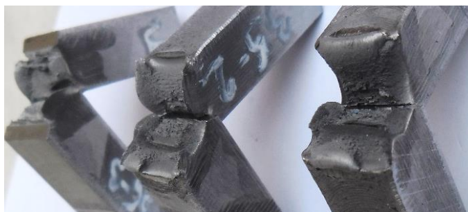
Слика 185. Изглед места прелома код епрувета са зарезом у зони утицаја топлоте са стране лица завареног споја изведеног варијантом МИГ/МАГ после испитивања
