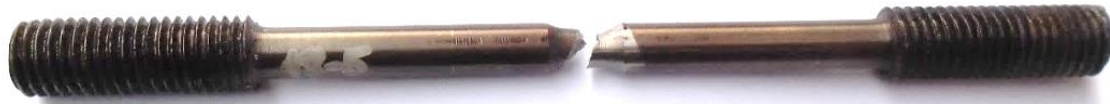
Слика 165. Изглед епрувете са варијантом МИГ/МАГ завареног споја и U -жлебом по обиму радијуса 10 mm после испитивања затезањем на 350°C
