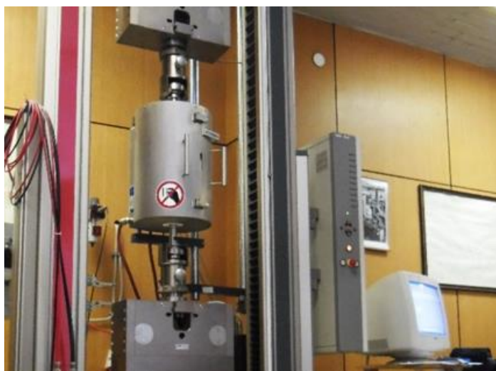
Слика 127. Комора са загревање на универзалном уређају за испитивање Zwick Roell z100
