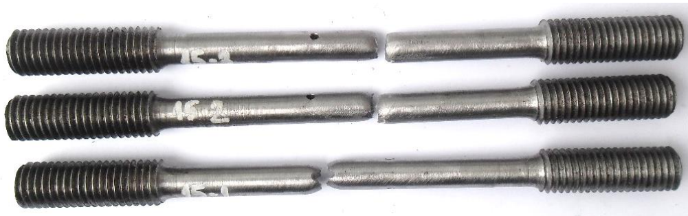
Слика 105. Изглед серије епрувета са мимоилазним отворима на растојању 15 mm после испитивања
