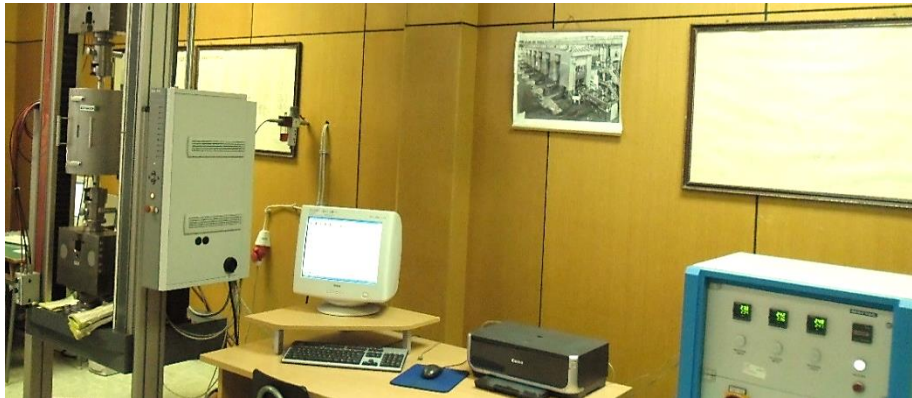
Слика 68. Универзални уређај за испитивање Zwick Roell z100
