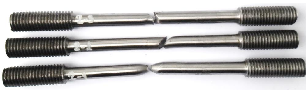
Слика 80. Изглед епрувета са варијантом МИГ/МАГ завареног споја после кидања
