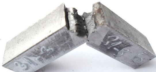
Слика 178. Изглед места прелома код епрувете са зарезом са стране лица у оси завареног споја изведеног варијантом МИГ/МАГ после испитивања на собној температури
