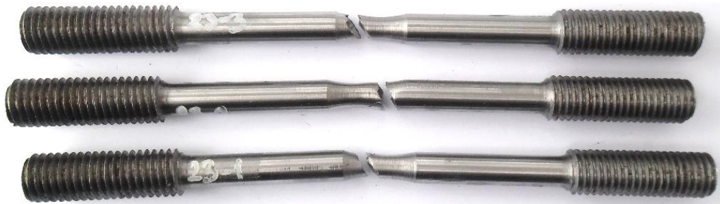
Слика 122. Изглед епрувета са варијантом РЕЛ/МАГ завареног споја са U -жлебом по обиму радијуса 30 mm после испитивања затезањем
