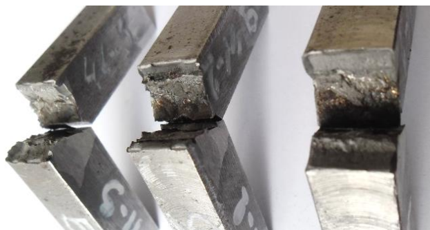
Слика 195. Изглед места прелома код епрувета са зарезом у зони утицаја топлоте са стране корена завареног споја изведеног варијантом МИГ/МАГ после испитивања
