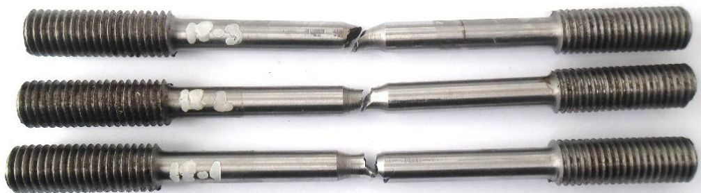
Слика 111. Епрувете са МИГ/МАГ варијантом завареног споја и U -жлебом по обиму радијуса 10 mm чије се осе поклапају после испитивања
