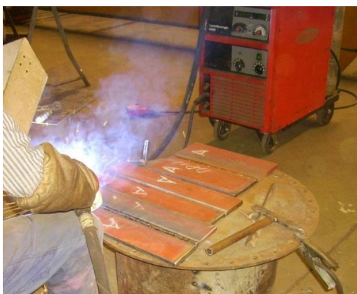
Слика 34. Уређај за заваривање и извођење пролаза попуне МАГ поступком
