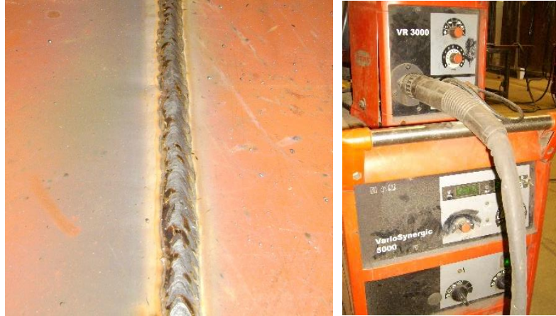
Слика 38. Заварени спој варијантом МИГ/МАГ и одговарајући уређај за заваривање
