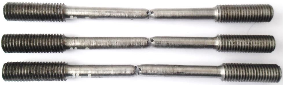
Слика 104. Изглед серије епрувета са мимоилазним отворима на растојању 10 mm после испитивања
