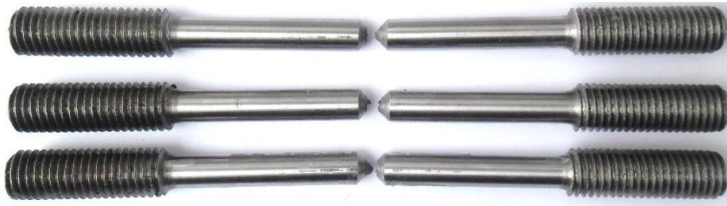
Слика 85. Изглед епрувета са V -жлебом по обиму после изведеног испитивања
