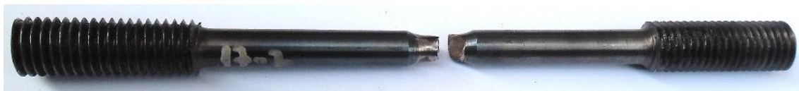
Слика 162. Изглед епрувете са варијантом РЕЛ/МАГ завареног споја и U-жлебом по обиму радијуса 10 mm после испитивања затезањем на 450°C
