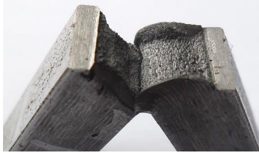
Слика 206. Изглед места прелома код епрувета са зарезом у зони утицаја топлоте са стране лица завареног споја изведеног варијантом РЕЛ/МАГ после испитивања
