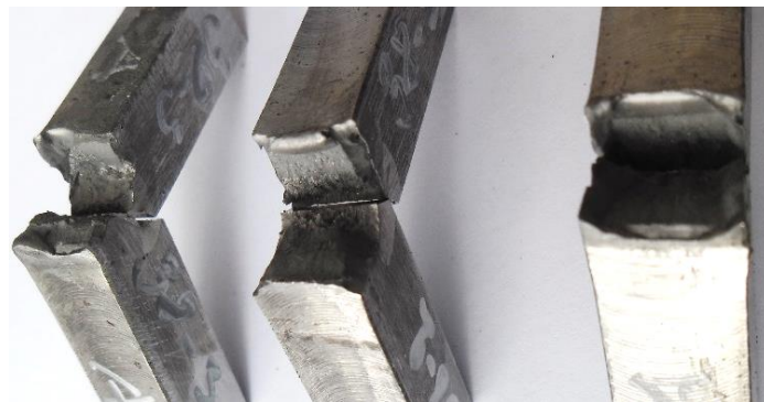
Слика 215. Изглед места прелома код епрувета са зарезом у зони стапања са стране корена завареног споја изведеног варијантом РЕЛ/МАГ после испитивања
