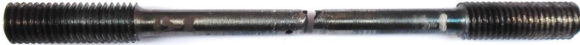
Слика 157. Изглед епрувете са мимоилазним отворима после испитивања затезањем до кидања на 450°C
