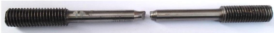
Слика 161. Изглед епрувете са варијантом РЕЛ/МАГ завареног споја и U-жлебом по обиму радијуса 10 mm после испитивања затезањем на 350°C
