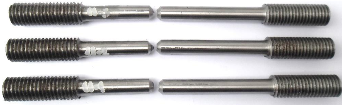
Слика 96. Епрувета са варијантом РЕЛ/МАГ завареног споја и V-жлебом по обиму на 10 мм од осе споја после изведеног испитивања
