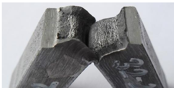
Слика 205. Изглед места прелома код епрувета са зарезом у зони стапања са стране лица завареног споја изведеног варијантом РЕЛ/МАГ после испитивања
