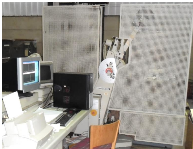
Слика 170. Шарпијево клатно са електричним давачима повезано са персоналним рачунаром
