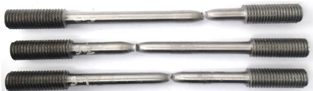
Слика 81. Изглед епрувета са варијантом РЕЛ/МАГ завареног споја после кидања
