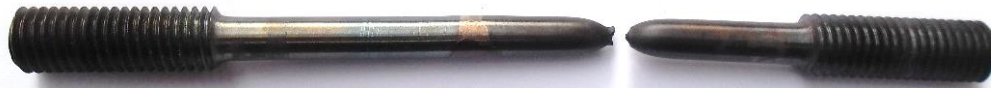
Слика 149. Изглед епрувете са варијантом МИГ/МАГ завареног споја после испитивања затезањем на 450°C
