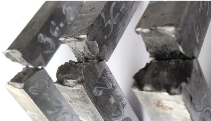
Слика 214. Изглед места прелома код епрувета са зарезом у оси са стране корена завареног споја изведеног варијантом РЕЛ/МАГ после испитивања
