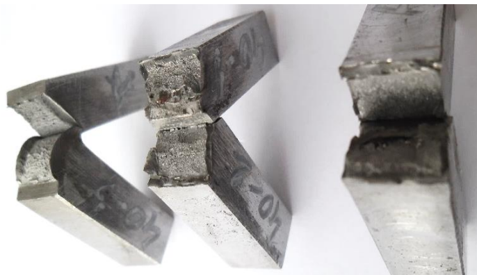
Слика 216. Изглед места прелома код епрувета са зарезом у зони утицаја топлоте са стране корена завареног споја изведеног варијантом РЕЛ/МАГ после испитивања
