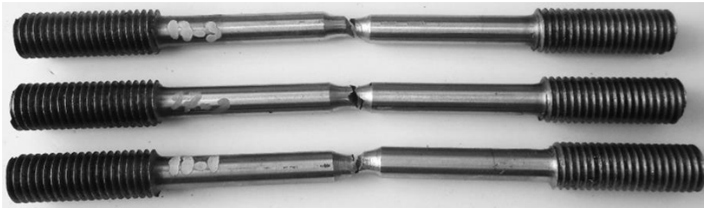
Слика 110. Епрувете са РЕЛ/МАГ варијантом завареног споја и U -жлебом по обиму радијуса 10 mm чије се осе поклапају после испитивања
