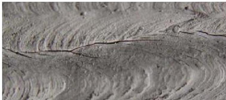
Слика 6. Водонична прслина формирана у зони утицаја топлоте са стране корена [101]
