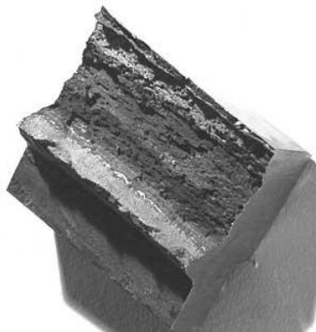
Слика 9. Површина лома услед развоја ламеларних прслина код угаоног завареног споја [117]
