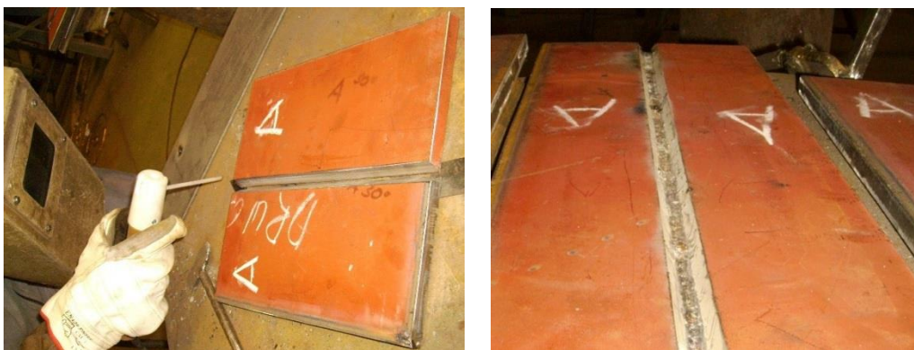
Слика 33. Полагање коренског пролаза РЕЛ поступком (лево) и изглед коренског пролаза после полагања (десно)
