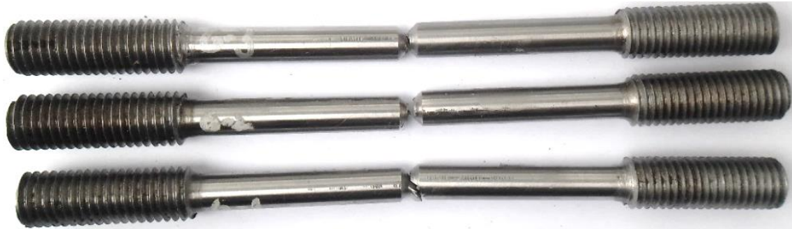
Слика 88. Изглед епрувета са варијантом МИГ/МАГ завареног споја и V-жлебом по обиму чије се осе поклапају после испитивања
