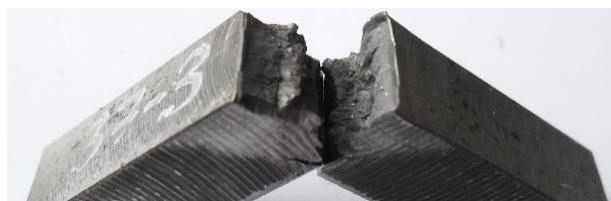
Слика 189. Изглед места прелома код епрувете са зарезом са стране корена у оси завареног споја изведеног варијантом МИГ/МАГ после испитивања на собној температури
