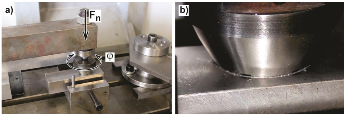
Слика 5.12 Поступак претходне припреме контакта, а) формирање контакта и претходна припрема и б) детаљ зоне контакта након спроведене претходне припреме контакта
