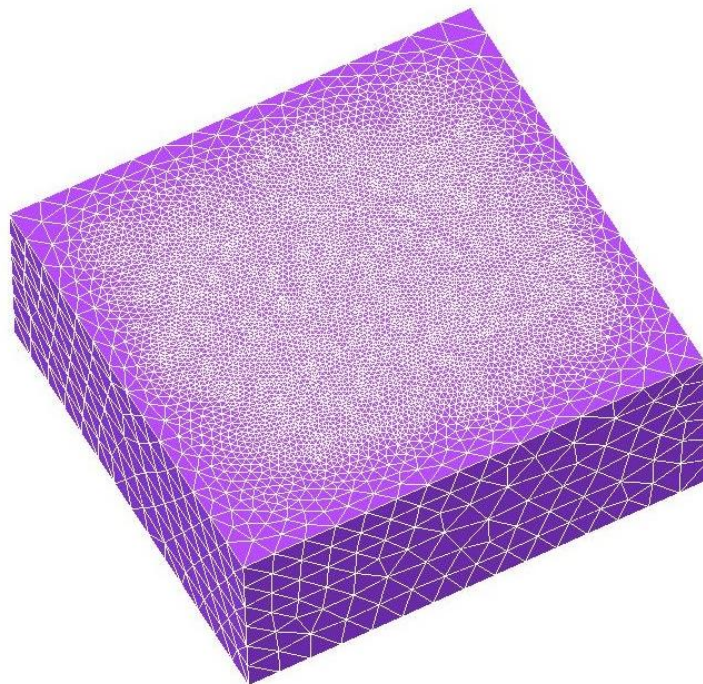
Слика 4.6 Мрежа коначних елемената стезног елемента са равном контактном површином
