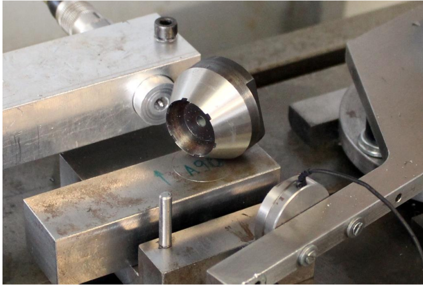
Слика 7.3 Фотографски приказ растављеног контактнoг пара након спроведених експерименталних истраживања
