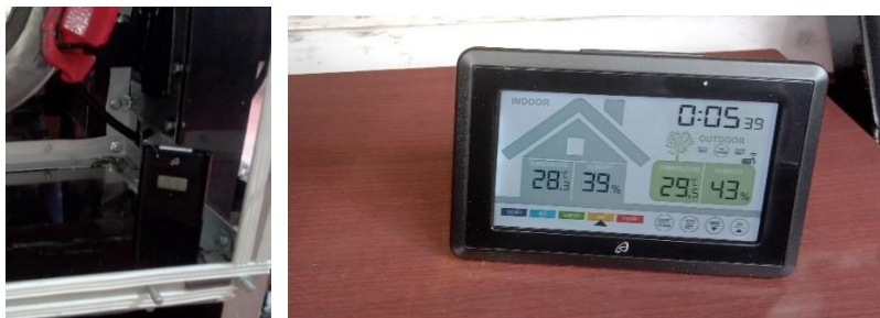
Слика 4.27 Уређај за мерење релативне влажности ваздуха и амбијенталне температуре унутар кућишта
