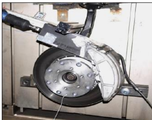
Слика 3.16 Додаци за сакупљање честица: а) додаток на кочници, б) додаток унутар кућишта [252, 253]
