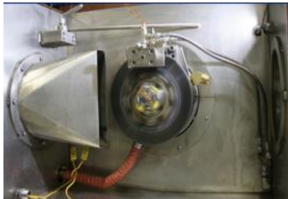
Слика 3.16 Додаци за сакупљање честица: а) додаток на кочници, б) додаток унутар кућишта [252, 253]
