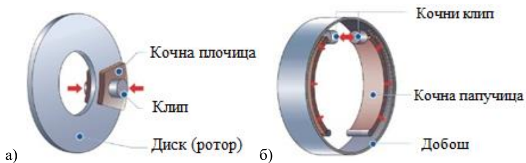
Слика 1.4 Принцип остваривања кочног момента: а) диск кочница, б) добош кочница [13]
