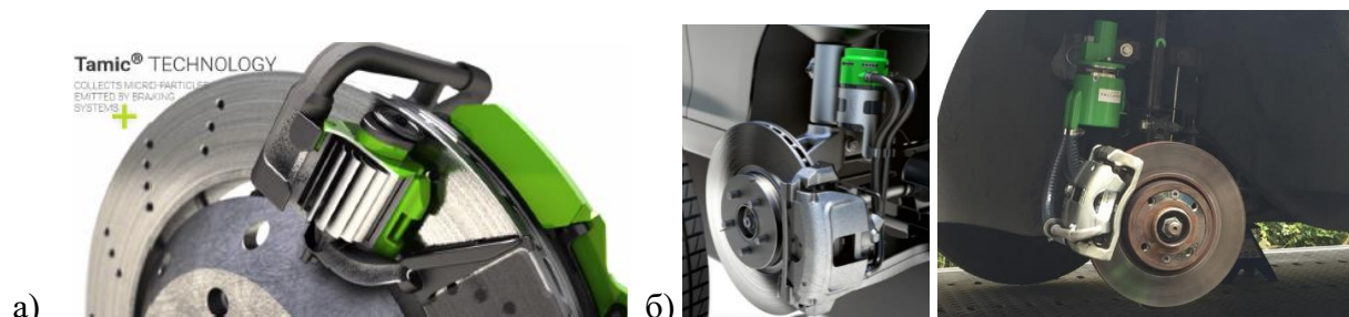
Слика 6.1 Концепт технологије на возилу за сакупљање честица: а) механички систем сакупљања честица б) електронски систем сакупљања честица [390, 391]
