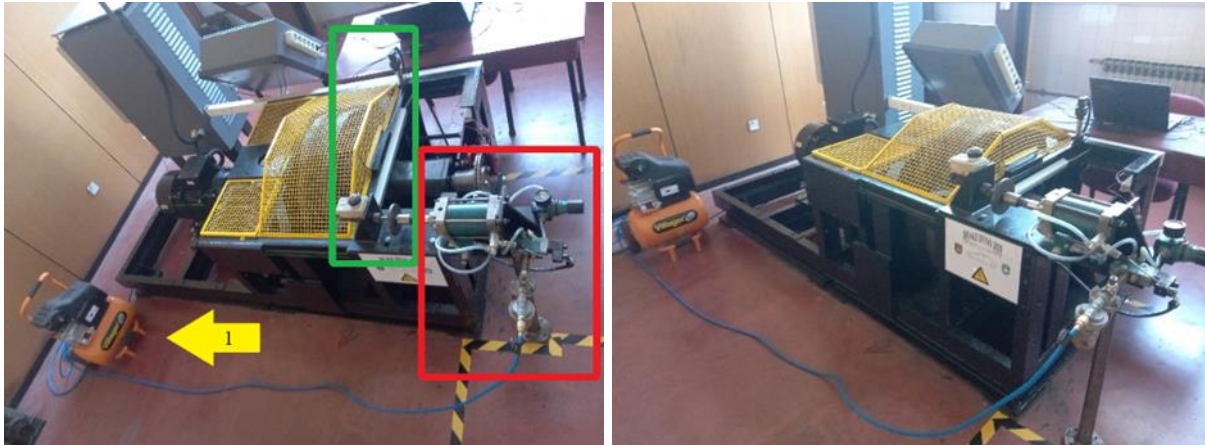
Слика 4.5 Приказ кочне инсталације: 1 - компресор за снабдевање ваздухом, црвено - пнеуматички део хидрауличке инсталације, зелено - хидраулички део инсталације
