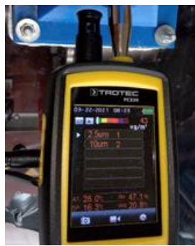
Слика 4.29 Провера концентрације честица у кућишту после пречишћавања ваздуха
