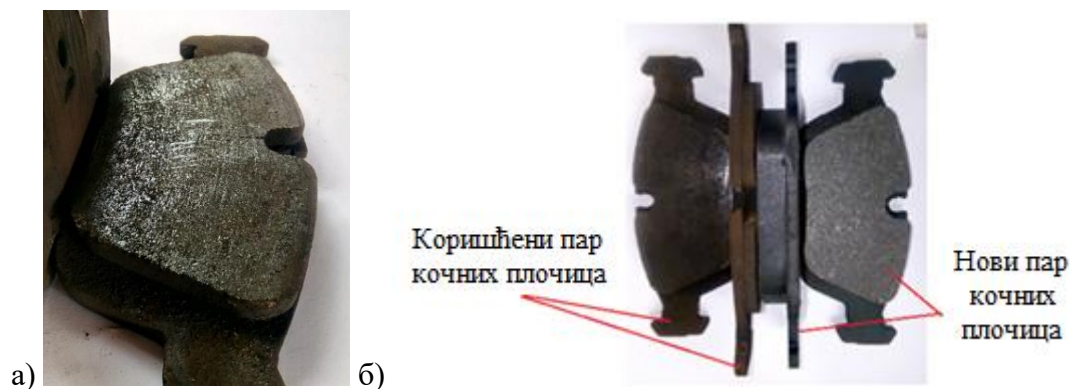
Слика 2.25 Фрикционе плочице: а) површина похабаних плочица б) упоредни приказ коришћених фрикционих плочица и нових фрикционих плочица
