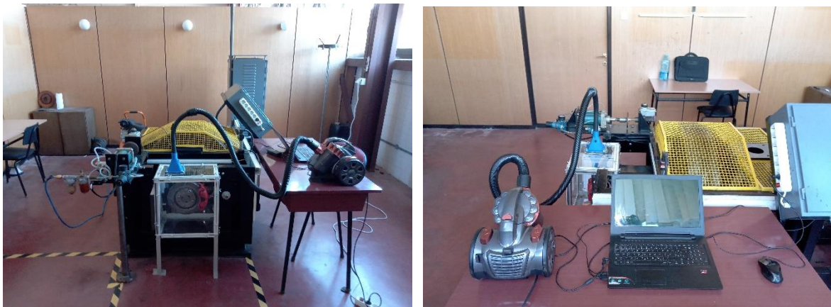
Слика 4.23 Елемент који повезује кућиште са уређајима за мерење честица и извлачење – пречишћавање ваздуха унутар кућишта
