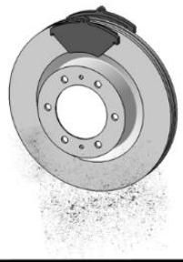
Слика 2.32 Ослобађање честица приликом кочења возила
