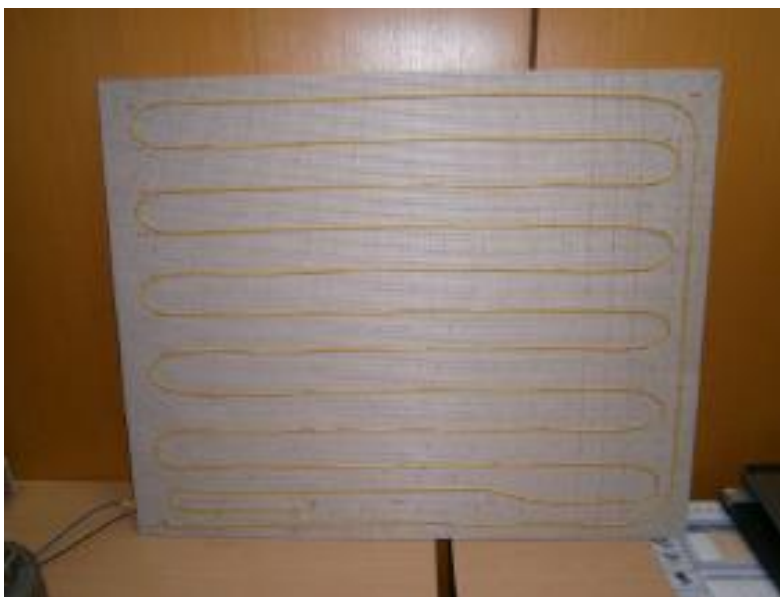
Слика 9.6. Монтажа грејног кабла [169]
