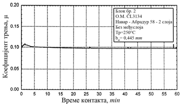
Слика 9.4.21 Промена коефицијента трења за време контакта од 60 min код блока бр. 2 (О.М.- ČL3134, D.M. навара - ABRADUR 58-2 слоја)
