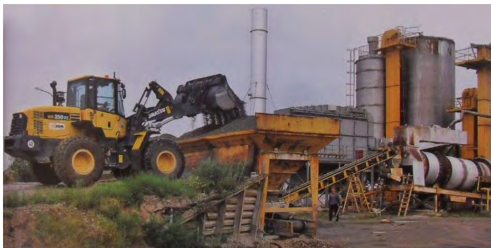
Слика 9.6.12 Изглед асфалтне базе капацитета 120 t/h
