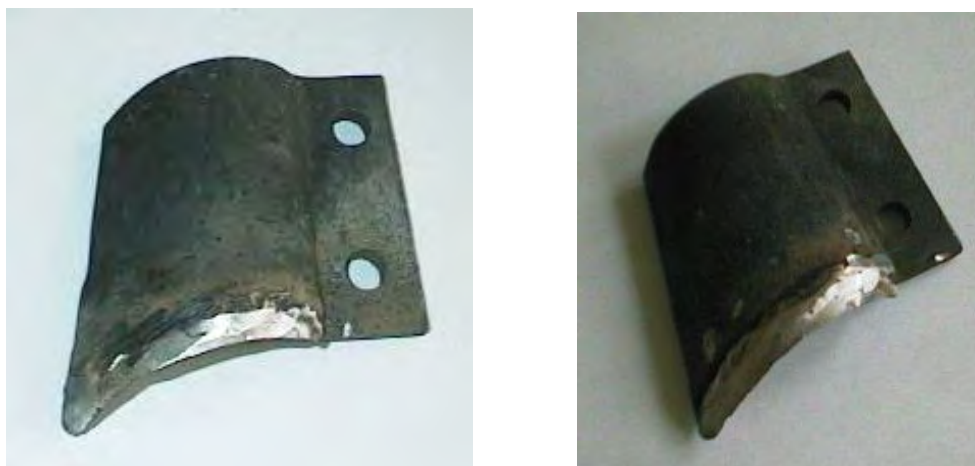
Слика 9.6.39 Изглед репаратурно наварених ножева уређаја за ископ канала после оштрења
