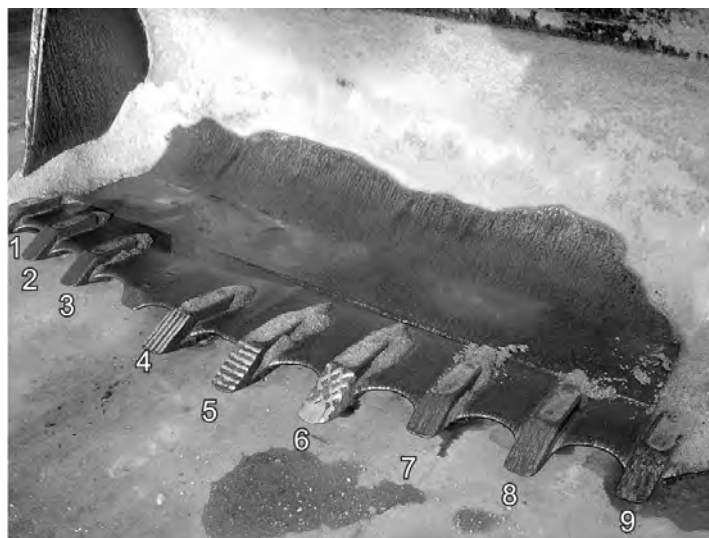
Слика 9.6.4 Начин монтаже испитиваних узорака зуба на утоварну кашику
