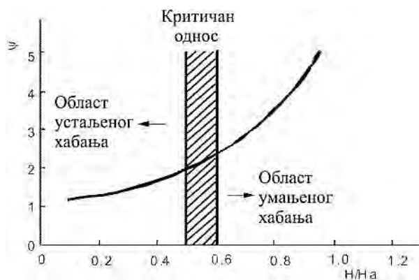
Слика 9.2.4 Зависност отпорности на абразивно хабање ( \psi ) од односа тврдоћа основног метала ( H ) и абразива ( H_a ) [14,100]
