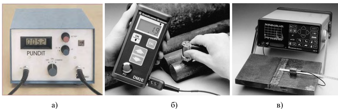
Слика 9.1.11 Приказ различитих врста ултразвучних уређаја: а) PUNDIT, б) DM2E, в) ION-3 [70,190]
