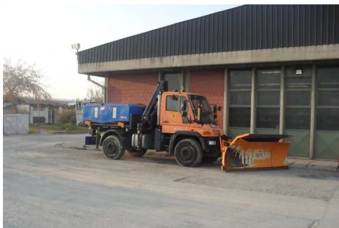
Слика 9.6.41 Изглед радне машине UNIMAG-640 са уређајима за чишћење снега
