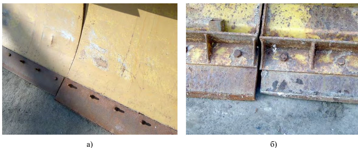
Слика 9.6.44 Похабаност ненаварених и наварених ножева плуга за чишћење снега: а) похабаност предње стране ножева, б) похабаност задње стране ножева
