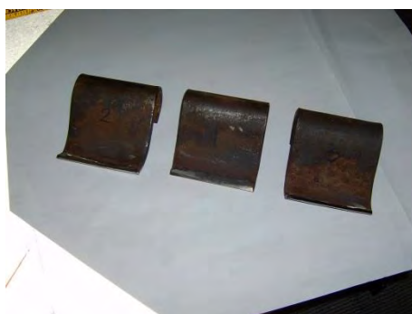
Слика 9.6.33 Изглед наварених и наоштрених ножева уређаја за равњање терена
