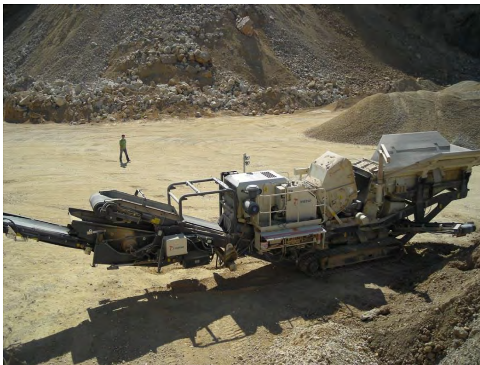
Слика 9.6.19 Изглед покретног дробиличног постројења капацитета 350 \text{ m}^3/\text{h}
