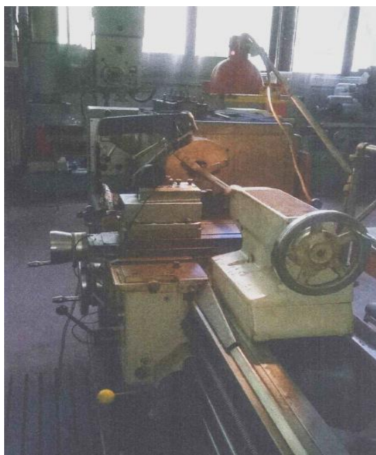
Слика 6.6. Универзални струг – BOEHRINGER UDF
