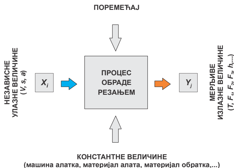
Слика 6.1. Шематски приказ процеса обраде резањем
