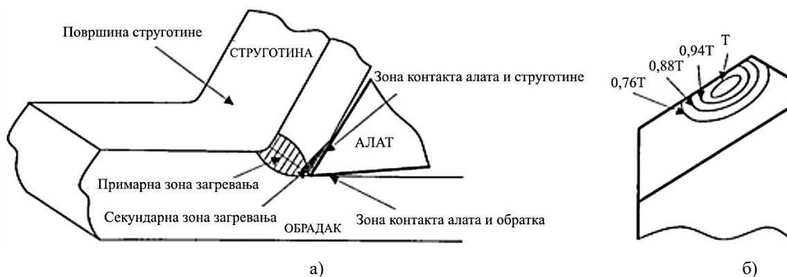
Слика 3.2. а) Зона загревања при машинској обради стругањем, б) Распоред температура на резном алату
