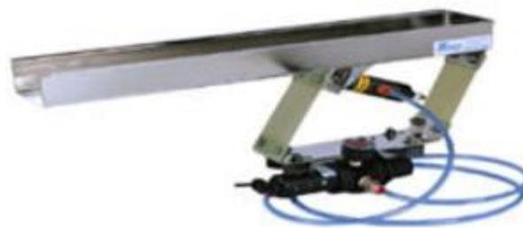
Слика 3. Вибрациони дозатор произвођача “MARTIN”, са пнеуматском побудом.
