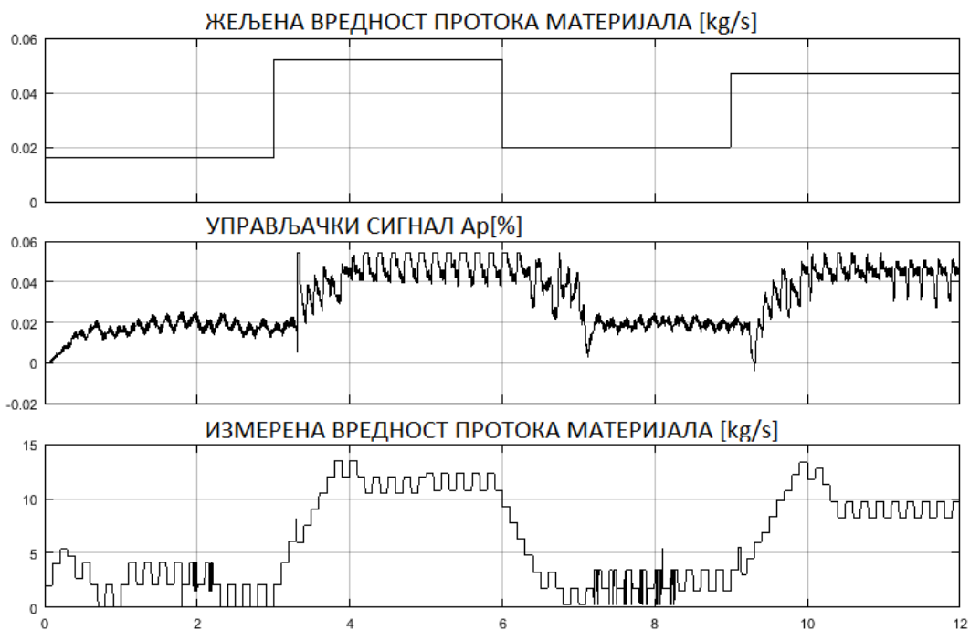
Слика 11. Одзив система на задату жељену вредност протока материјала. Период одабирања T_s = 1 \text{ ms} . Период одабирања МПЦ контролера T = 0.1 \text{ s} .
