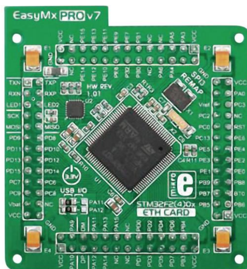
Слика 31. Модул са микроконтролером STM32F407VGT6 (произвођач Микроелектроника Београд).
