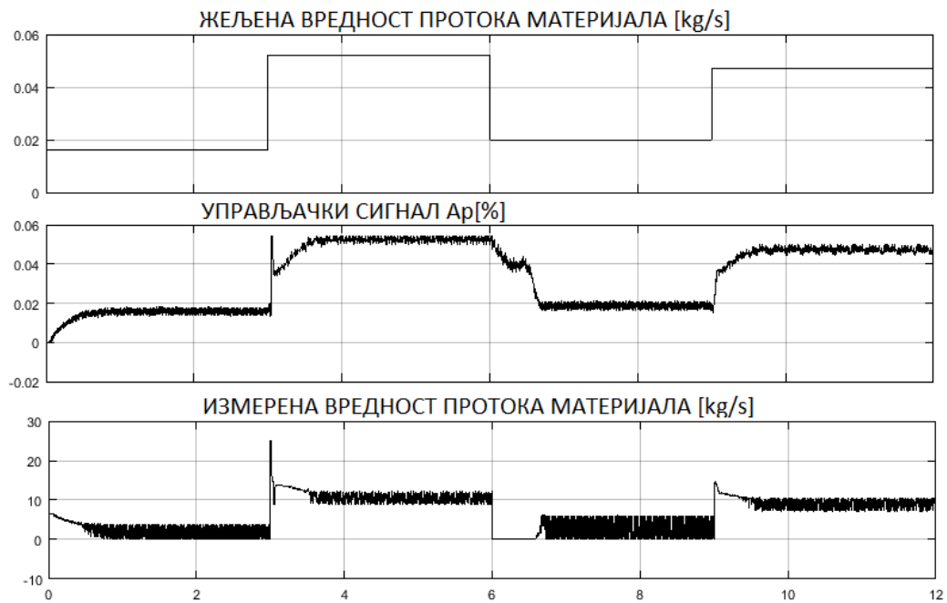
Слика 14. Одзив система на задату жељену вредност протока материјала. Период одабирања T_s = 100 \mu s . МПЦ контролер наслеђује период одабирања.
