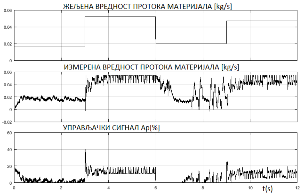
Слика 4.1. Одзив система на задату жељену вредност протока материјала, за T_s = 0.001 s ( A \geq 0 ).
