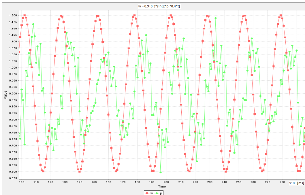
Слика 2. Одзив система на задату жељену вредност амплитуде осциловања корита ( w = 0.9 + 0.3 \cdot \sin(2 \cdot \pi \cdot 0.4 \cdot t) ). МПЦ контролер, T_s = 0.1 s.
