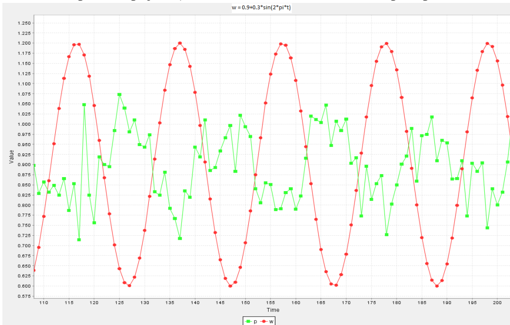
Слика 1. Одзив система на задату жељену вредност амплитуде осциловања корита ( w = 0.9 + 0.3 \cdot \sin(2 \cdot \pi \cdot t) ). МПЦ контролер, T_s = 0.05 s.
