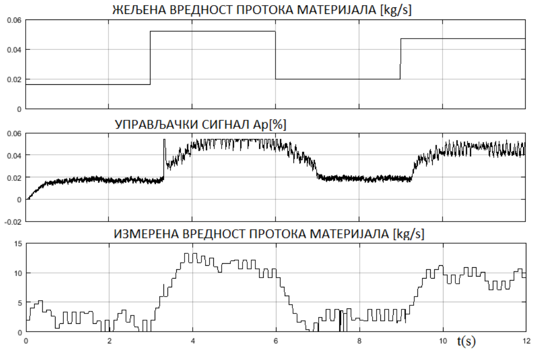
Слика 13. Одзив система на задату жељену вредност протока материјала. Период одабирања T_s = 500 \mu s . Период одабирања МПЦ контролера T = 0.1 s .
