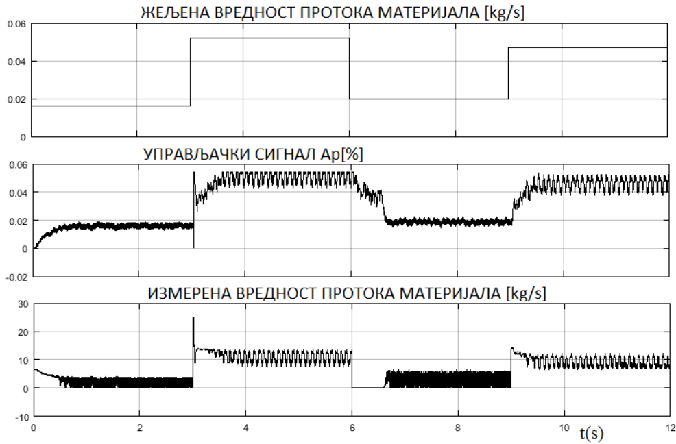
Слика 53. Одзив система са МПЦ контролером у наследном режиму за T_s = 0.0005 s.
