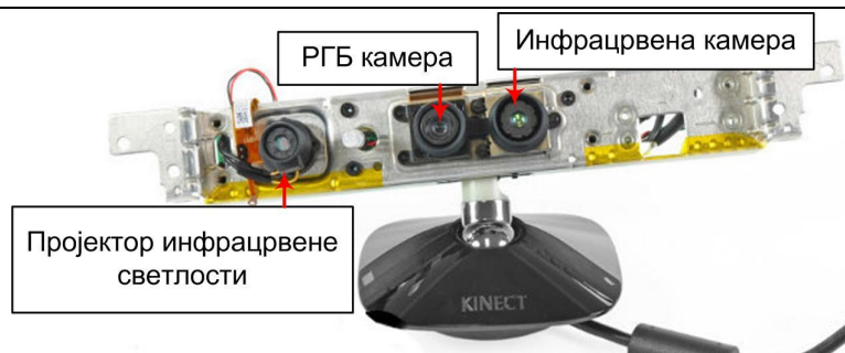
Слика 4.19. Пројектор инфрацрвене светлости, инфрацрвена и РГБ камера [Zhang Z. (2012), Rafibakhsh N. (2012)]
