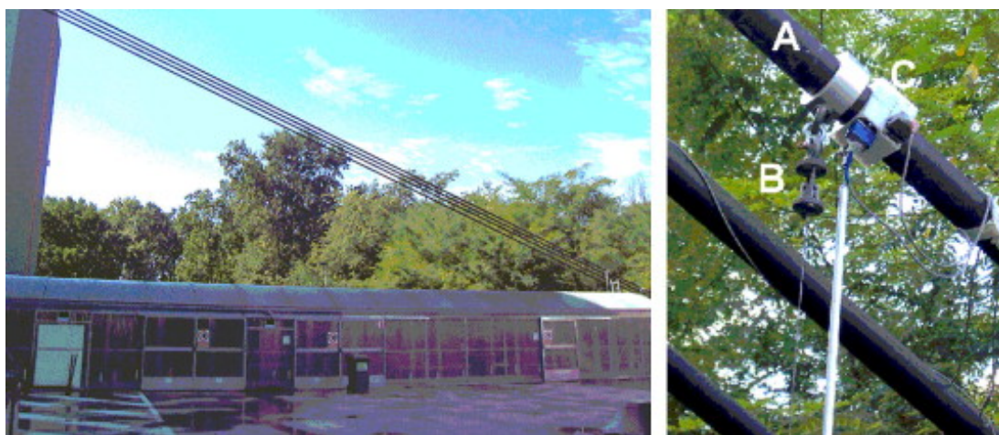
Слика 1.18: Четири кабла од 45 m у ELSA (European Laboratory for Structural Assessment). (A) кабал; (B) SMA пригушивач; (C) акцелерометар за истраживања [23, 27]
