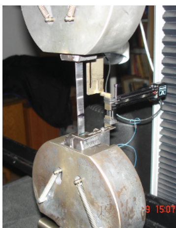
(а) TiNi SMA у чељустима кидалице екстензометра
