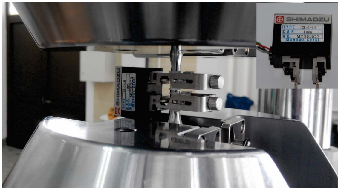
Слика 3.11 Екстензометар SHIMADZU DYNASTRAIN TCK-1-LH
