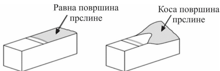
Слика 2.24 Облици прслине настали при расту прслине затезним обликом отварања прслине.
