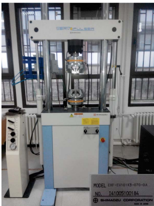
Слика 3.1 Сервохидраулични пулзатор/кидалица SHIMADZU тип EHF-EV101K3-070-0A
