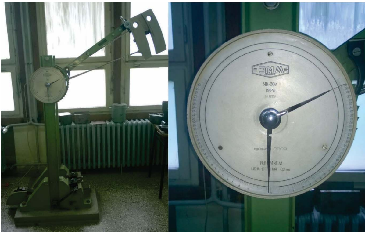
Слика 3.17 Шарпијево клатно типа МК-30А
