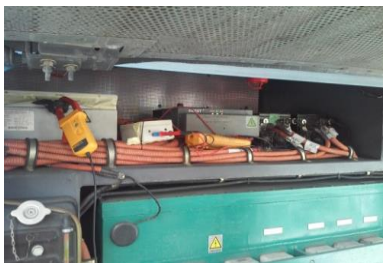
Слика П3.4 Мерење струје потрошње система за грејање путничког и возачевог простора
