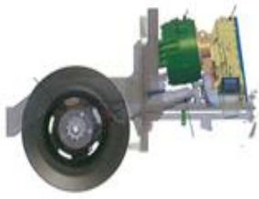
Слика 3.6 Погонски електромотор уграђен на класични начин [88]
