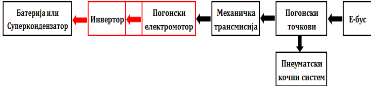
Слика 5.4 Токови електричне и механичке енергије код Е-буса у фази кочења
