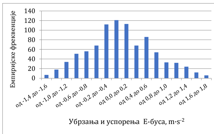
Слика 6.9 Расподела остварених убрзања и успорења на линији ЕКО 1, смер "А" у периоду 7:38:01 до 8:09:30, Е-бус 2104, 28.06.2018. године
