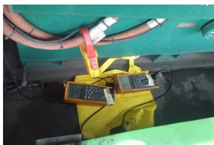
Слика П3.2 Мерење напона и струје пражњења/пуњења суперкондензатора
