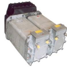
Слика 3.8 Погонски електромотори упарени помоћу збирног преносника снаге [90]
