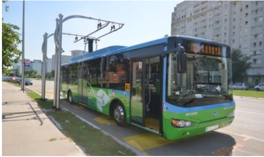
Слика П2.1 Пуњење Е-буса терминус "Белвил", 3x380 V (AC)
