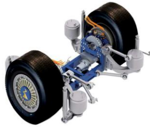
Слика 3.7 Погонски електромотори уграђени у тачкове погонске осовине [89]
