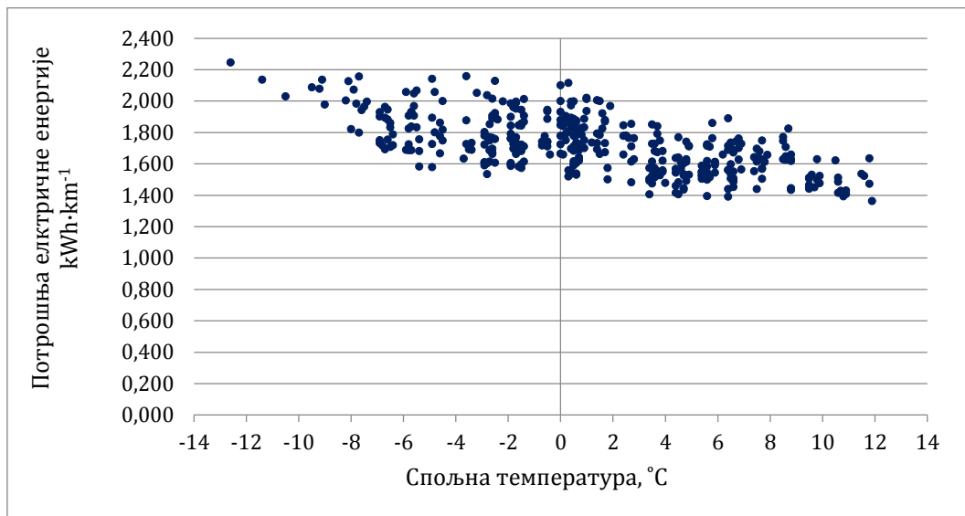
Слика 6.38 Остварене потрошње електричне енергије Е-буса и спољне температуре, смер "Б", зимски период
