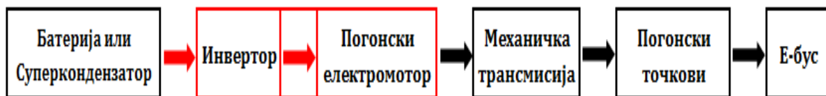
Слика 5.2 Токови електричне и механичке снаге код Е-буса
