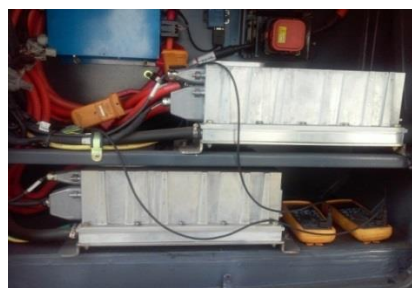
Слика П3.3 Мерење струје потрошње и рекуперације на инверторима погонских мотора
