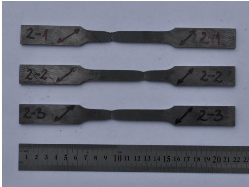
Слика 3.22 S355 челичне епрувете сечене под углом од 45° у односу на правац ваљања после експерименталног испитивања
