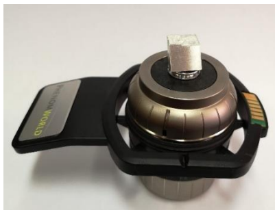
Слика 9.17 Узорак за СЕМ анализу, 5083, стање Н111, са осом затезања под углом од 45^\circ у односу на правац ваљања
