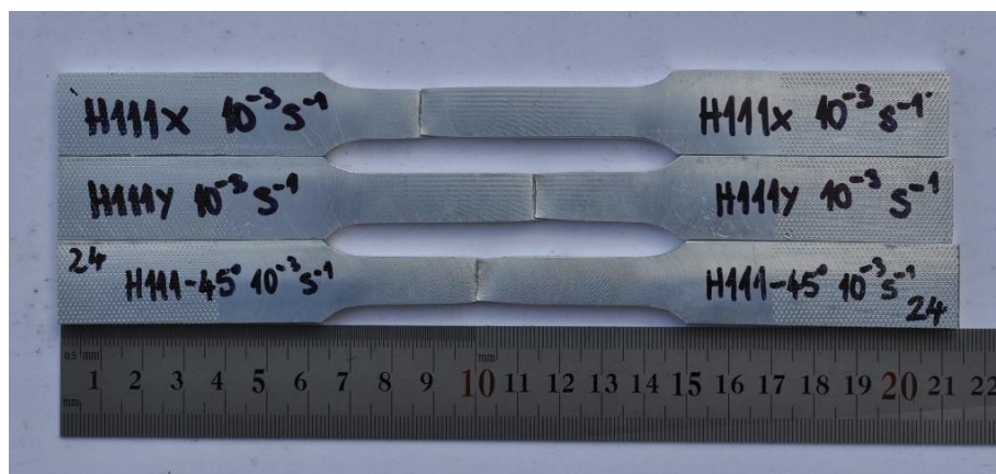
Слика 3.17 Епрувете алуминијумске легуре 5083, стање H111, после једносног испитивања
