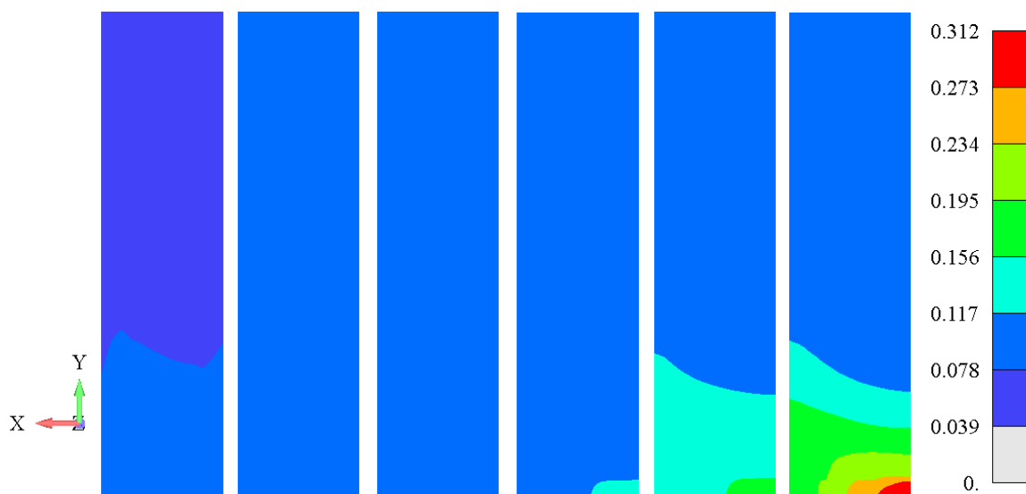
Слика 6.35 Развој фазног поља оштећења d у посткритичној зони са покретним интерфејсом за померање горње површине епрувете H321 0^\circ за а) 6.76mm, б) 6.80mm, в) 6.84mm, г) 6.88mm, д) 6.92mm, ђ) 6.96mm
