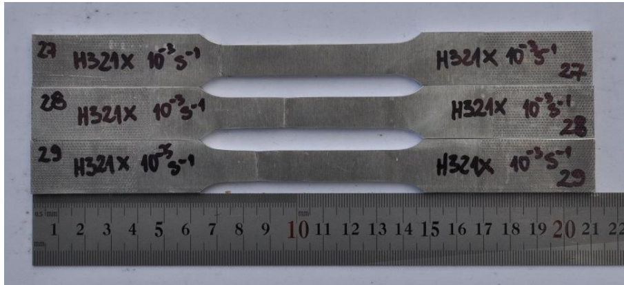
Слика 3.15 Епрувете сечене управно на правац ваљања, стање Н321, после експерименталног једноосног испитивања
