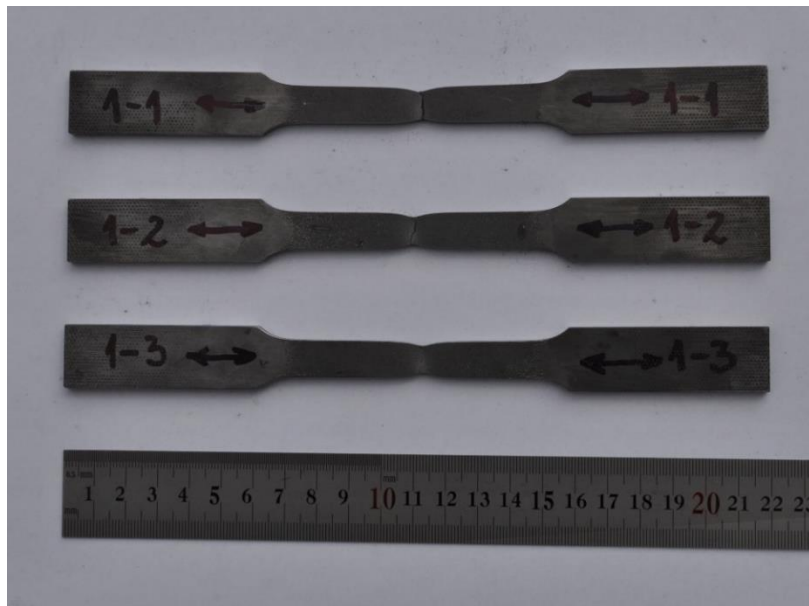
Слика 3.20 S355 челичне епрувете сечене у правцу ваљања после експерименталног испитивања
