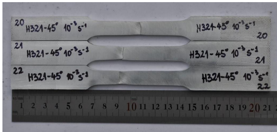
Слика 3.13 Епрувете сечене у правцу под углом од 45° у односу на правац ваљања, стање H321, после експерименталног једноосног испитивања
