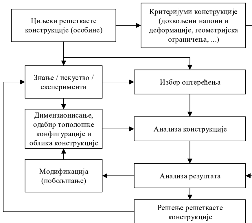
Слика 2.7 – Конвенционални поступак конструисања решеткастих носача.
