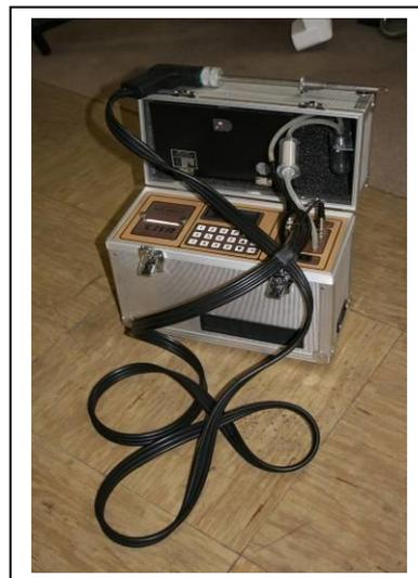
Namena: Merenje emisije CO, NO, NO<sub>2</sub>, O<sub>2</sub>, SO<sub>2</sub>, CO<sub>2</sub>, merenje dimnosti, merenje temperature, pritiska (diferencijalno)
