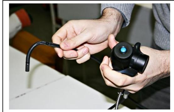
Namena: Videoskop služi za vizuelni inspekciju teško dostupnih mesta i spada u tzv. ne destruktivne dijagnostičke metode.
