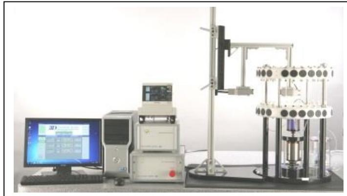
Namena: Oprema služi za neophodna testiranja različitih vrsta stentova manjih prečnika u vertikalnom položaju, testiranje životnog ciklusa i radijalno testiranje na zamor, deo nacionalnog projekta III41007, rukovodilac prof. dr Nenad Filipović
