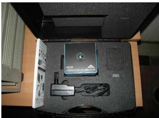
Namena: Oprema služi za kalibraciju davača ubrzanja
