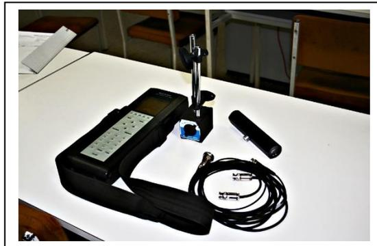
Namena: Merenje i analiza vibracija, balansiranje u sopstvenim ležajevima do 4 ravni balansiranja. Komplet sadrži:
