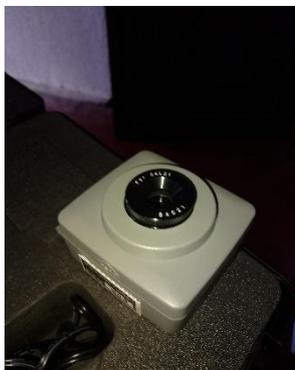
Namena: Oprema služi za kalibraciju mikrofona
