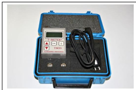
Namena: Uređaj služi za ultrazvučno merenje debljine materijala
