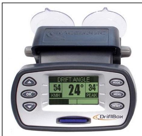
Namena: Uređaj za akviziciju pređenog puta, brzine, ubrzanja i opterećenja vozila na osnovu GPS podataka
