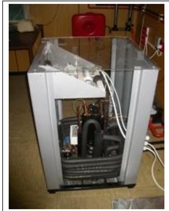
Namena: Oprema služi za korišćenje otpadne, geotermalne, solarne energije za grejanje vode.
