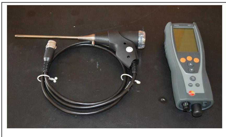
Namena: Oprema služi za merenje sadržaja O<sub>2</sub> i CO u dimnim gasovima.
