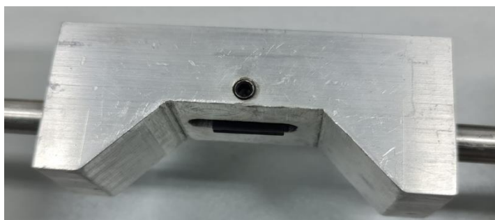
Слика 13 – Специјални резни алат (а) са носачем алата (б)
