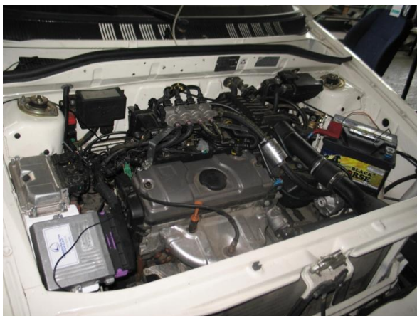
Сл.5 Уградња секвенцијалног система за ТНГ
