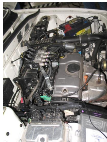
Сл.5 Уградња секвенцијалног система за ТНГ
