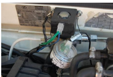
Сл.12 Уградња елемената система за КПГ у моторски простор
