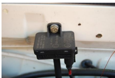
Сл.12 Уградња елемената система за КПГ у моторски простор
