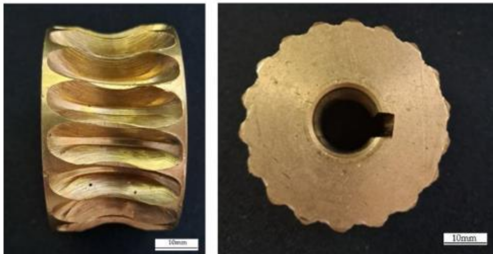
Слика 8.27 Фотографије пужних зупчаника снимљене помоћу микроскопа LEICA M205 A
