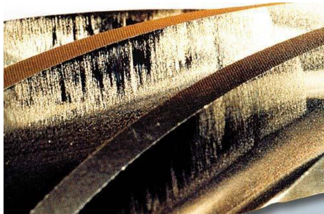
Слика 4.13 Приказ гребања на контактним површинама [60]
