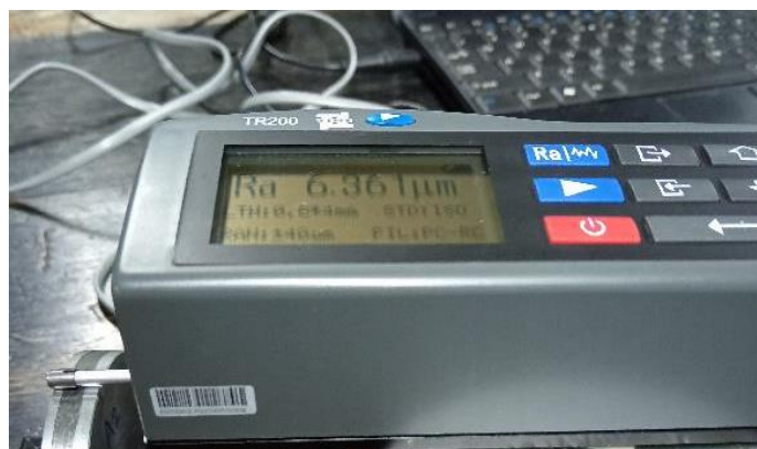
Слика 6.18 Приказ мерења храпавости диска од бронзе ZA-12 уређајем TR-200
