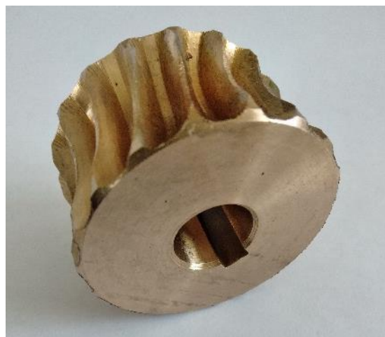
Слика 6.21 Пужни зупчаник израђен од калајне бронзе CuSn14
