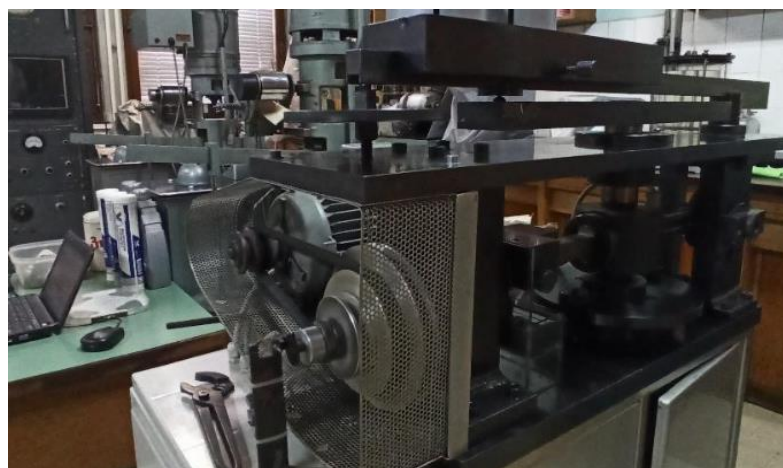
Слика 6.13 Приказ трибометра TPD 95 са мерним уређајима и дијагностичком опремом
