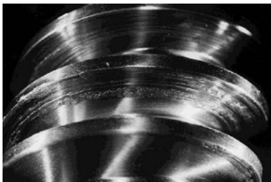
а) оштећења на боку зупца пужа
