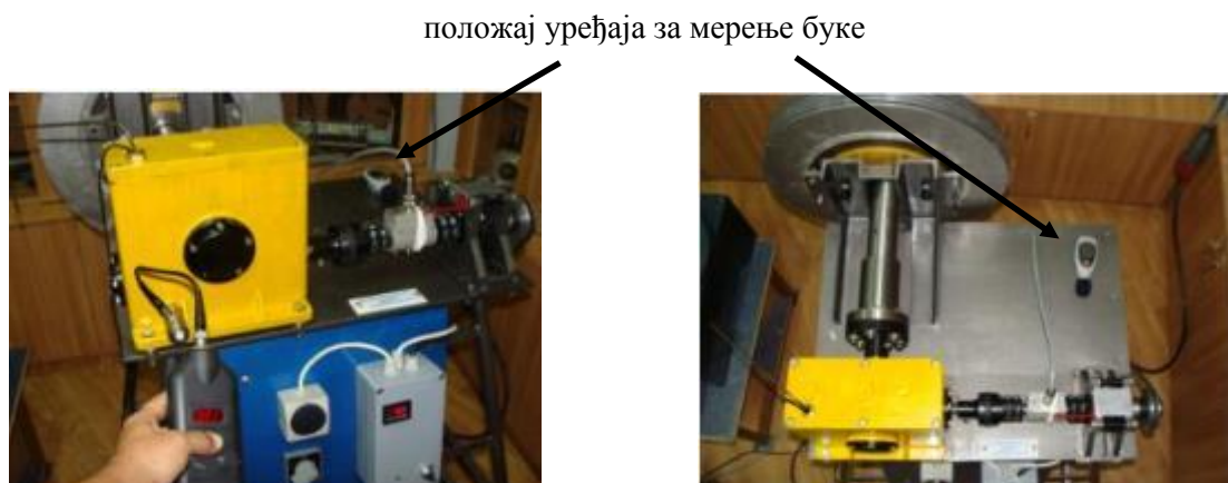
Слика 4.16 Приказ уређаја за мерење буке на испитном столу [32]
