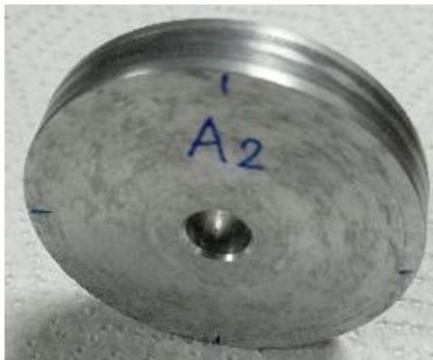
Слика 7.8 Приказ диска од бронзе ZA-12 са обележеним местима по ободу диска на којима је мерена хrapавост
