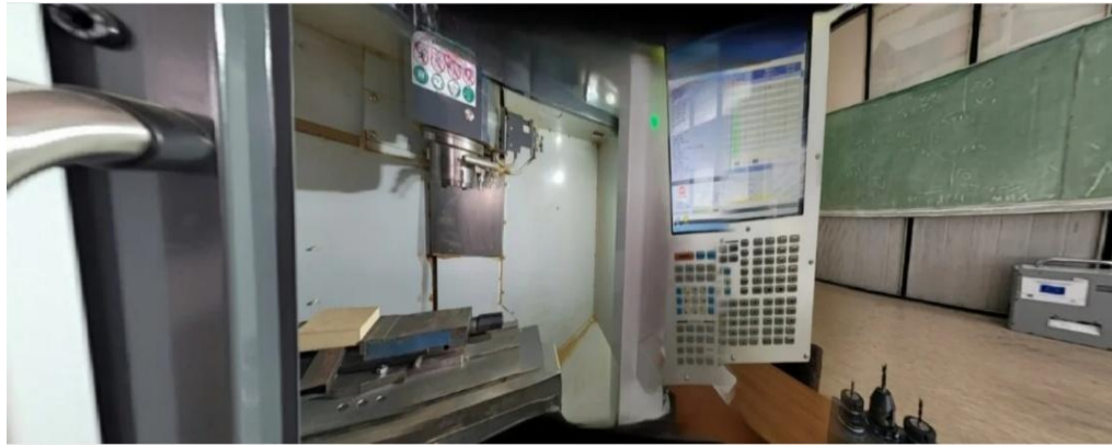
Слика 6. Приказ 360° правилног постављања обрадка на радни сто машине
