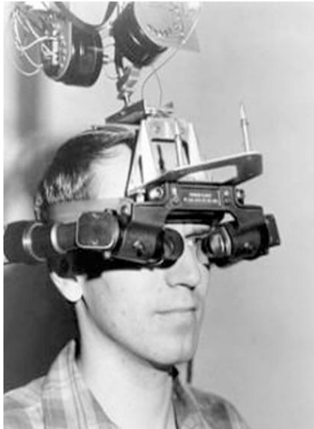
Слика 2. „Sword of Damocles“ (први HMD уређај)
