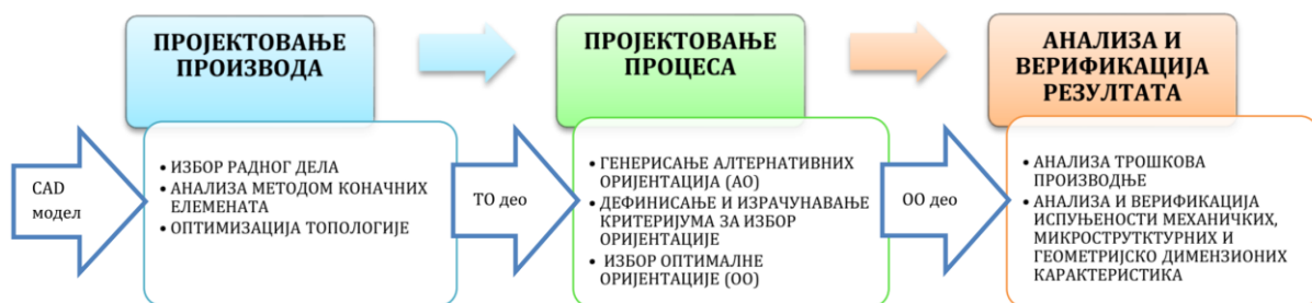
Слика 15: Предлог новог оквира за пројектовање производа и процеса применом адитивне L-PBF методе.
