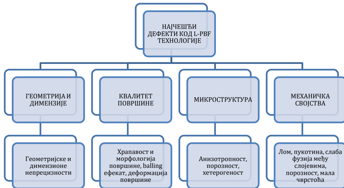
Слика 21: Приказ најчешћих дефеката у процесу израде делова применом L-PBF адитивне технологије, (Malekiour и El-Mounayri, 2018).
