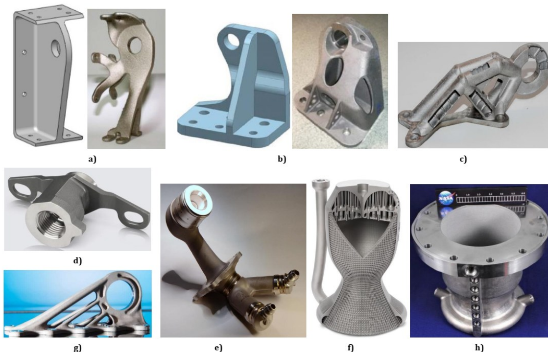
Слика 8: Делови произведени L-PBF технологијом за примену у авио-индустрији: а) држач пре и након тополошке оптимизације, б) држач пре и након термоеластичне оптимизације, ц) држач сложеног облика, д) бороскоп, е) млазница за гориво, ф) млазница ракетног мотора, г) кабински конектор, х) комора за сагоревање, (Ali и др., 2022).
