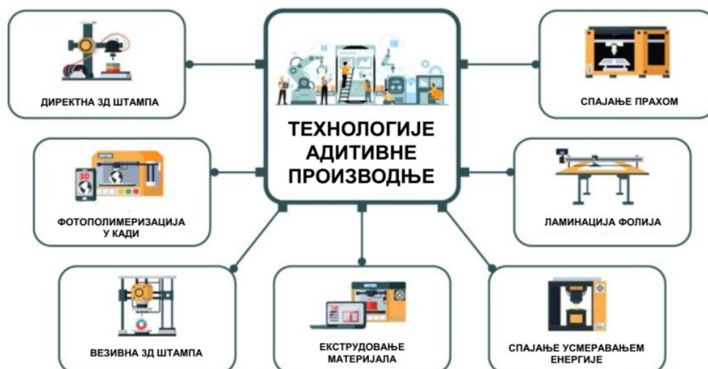
Слика 6: Седам основних технологија адитивне производње, (ISO, 2021).
