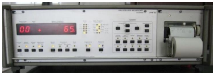
Слика 5.11 Уређај за читавање измерене вредности температуре (HBM UPM 60)
