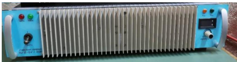
Слика 5.4 Стабилисани исправљач: напон од 12V-15V, јачина струје 30 A
