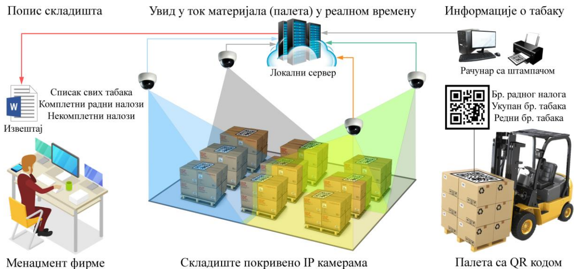
Слика 5.1 Концепт и елементи дигиталног складишта палета.
