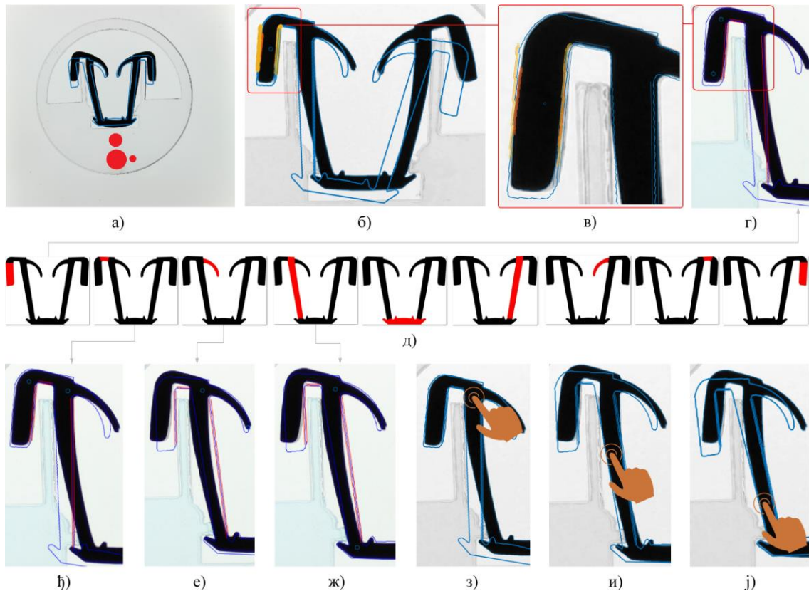
Слика 4.18 Аугментација техничког цртежа преко корегистрованих референтних тачака. а) Почетна аугментација након калибрације система; б-г) Аугментација помоћу алгоритма итеративног налажења најближе тачке (наранџаста боја означава облак тачака изабран за аугментацију); д) Скица предефинисаних области које је потребно визуелно преконтролисати; ђ-ј) Преклапање техничког цртежа преко предефинисаних подручја (на слици се може видети како је врат савијен, што захтева додатну интеракцију корисника); з-ј) Инспекција левог врата коришћењем функције локалног поравњања.
